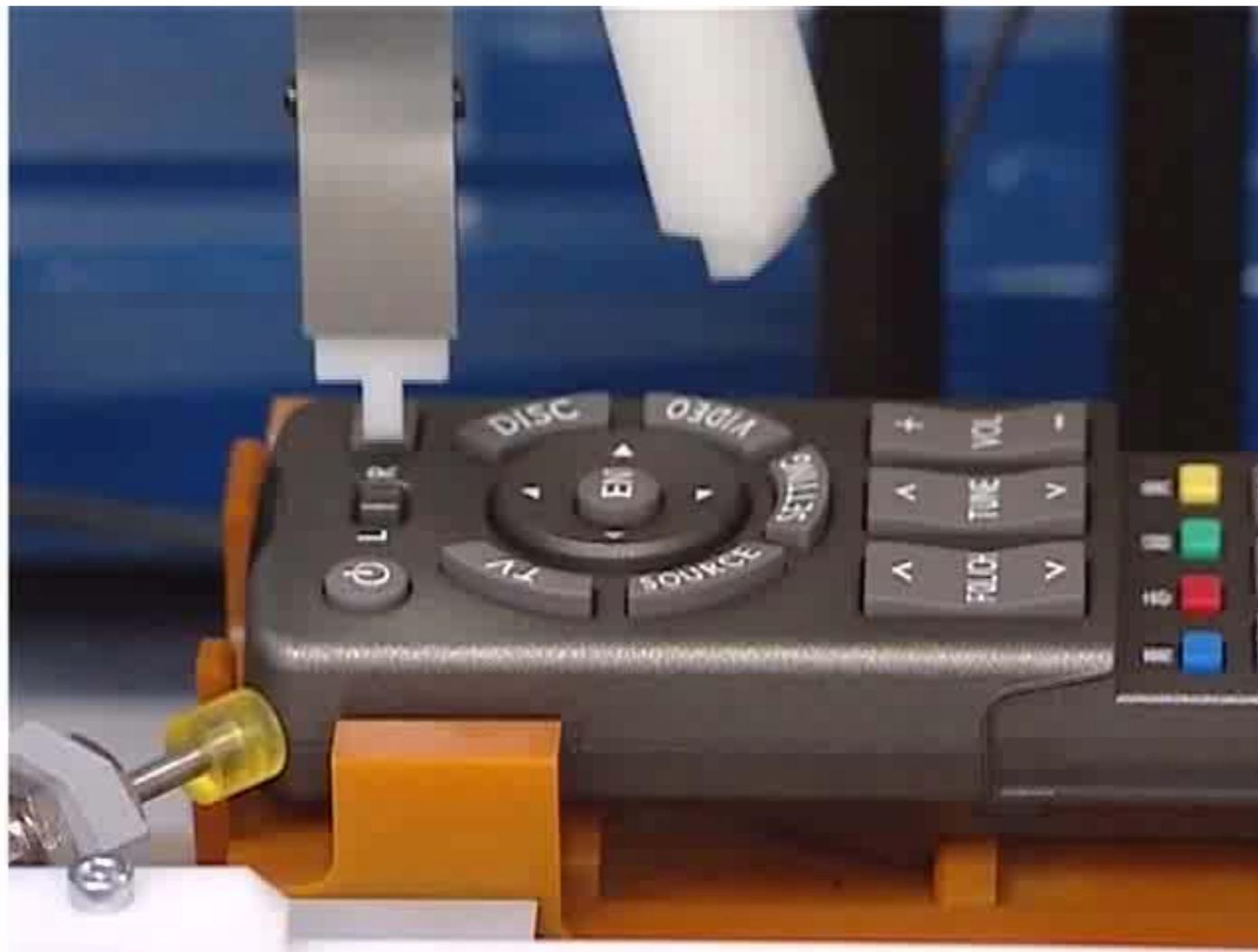
汎用自動リモコン検査機、組立機(再生時間:20秒)
