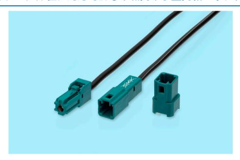
当社はこのほど、車載機器向けに 1.5D と 2.5D のケーブルが共用可能な小型同軸コネクタ「MH-2 シリーズ」を開発しました。本製品は、ハウジングを共通化することにより、1.5D と 2.5D の太さの異なる同軸ケーブル同士の接続を可能としたコネクタです。また、同軸ケーブルを基板に接続するための基板プラグも用意しています。
