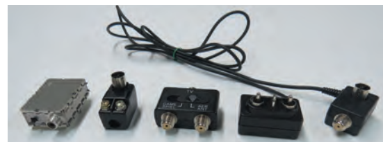
左からRFモジュレータ、整合器、RFセレクト、 スイッチ付RFモジュレータ
